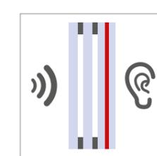
**Dreifachverglasung mit Schalldämmfolie**
